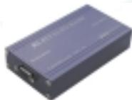
Box di controllo RS422 per controllo da sistemi di editing NLE
